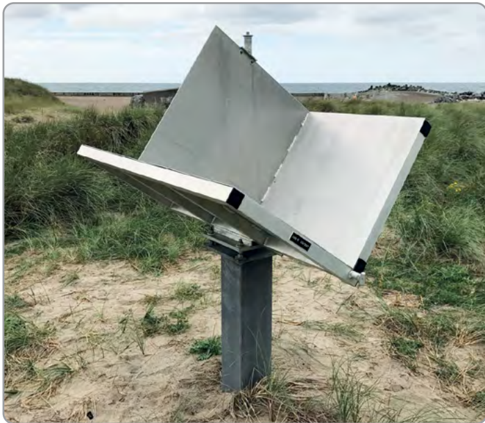
Die Winkelreflektoren wurden von DTU Space und dem Amt für Datenversorgung und Effizienz entwickelt und vom Wasserversorger in Lemvig hergestellt. Mit den Reflektoren können Höhenänderungen in den Erdbeobachtungsdaten mit dem dänischen Datennetz verknüpft werden (Foto mit freundlicher Erlaubnis von Herrn Karsten Vogensen).
