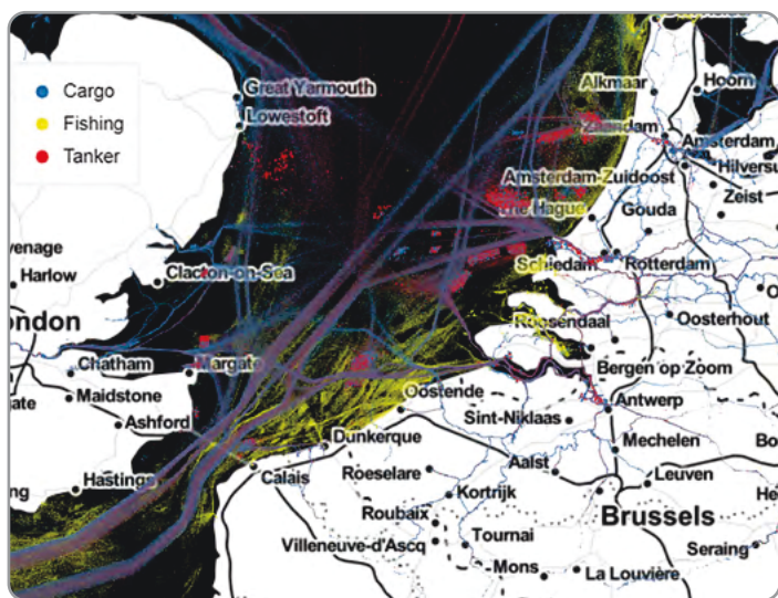
Distribuzione dei messaggi AIS usati per insegnare al sistema a riconoscere automaticamente i diversi tipi di natanti.
