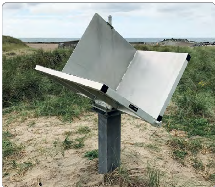
Riflettore radar sviluppato da DTU Space e dall'Agency for Data Supply and Efficiency e prodotto dall'azienda di pubblici servizi di Lemvig. I riflettori vengono usati per collegare le variazioni di altezza misurate dai dati EO alla rete fognaria danese (foto su gentile concessione di Karsten Vognsen).
