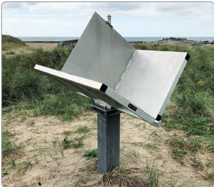
Reflektor narożnikowy opracowany przez DTU Space oraz Agencję ds. Zaopatrzenia w Dane i Efektywności, wyprodukowany przez Lemvig Utility. Reflektory służą do łączenia zmian wysokości pozyskanych zdalnie z duńską siecią datum (Zdjęcie za zgodą Karstena Vognsena).
